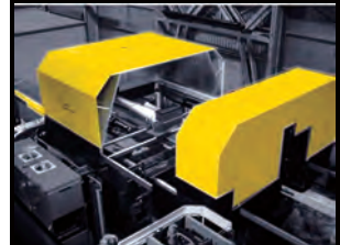
Fahrbare Absaughaube für Druckgießmaschinen sind als 1 oder 2-teilige Haube oder als Luftschleier lieferbar
