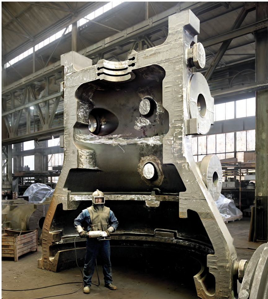
Bild 3: Blick in die Putzerei bei Ergocast Guss: Das 38 t schwere Gussteil aus dem Handformguss ist für den Einsatz in der Energieerzeugung vorgesehen.
