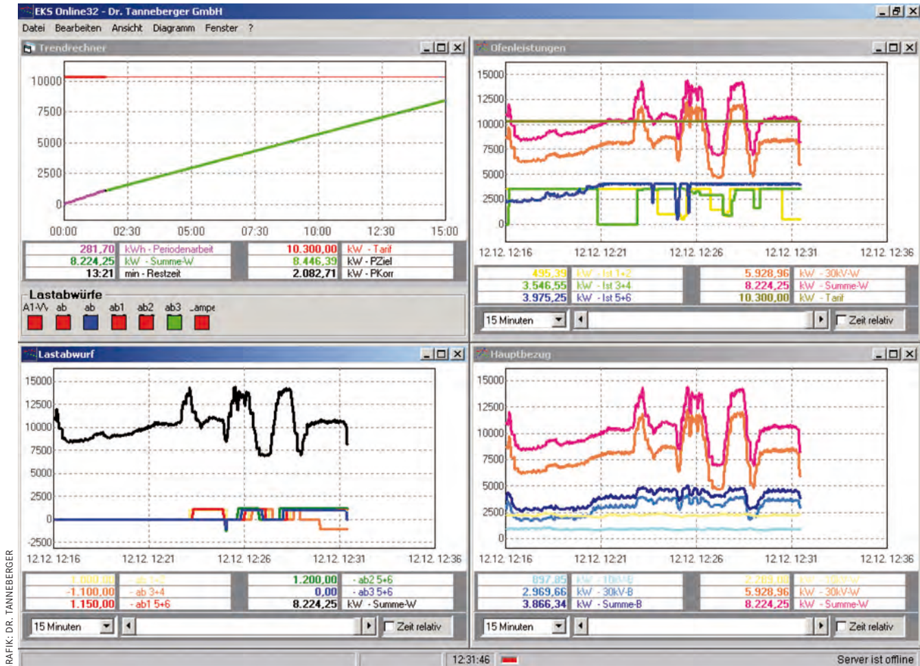
Bild 5: Typische Aufnahme vom Onlinemonitoring einer „Padicon“-Anlage. Das Monitoring sorgt für Transparenz beim Stromverbrauch.
