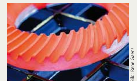
Glühendes Zahnrad während des Härtingsprozesses.
