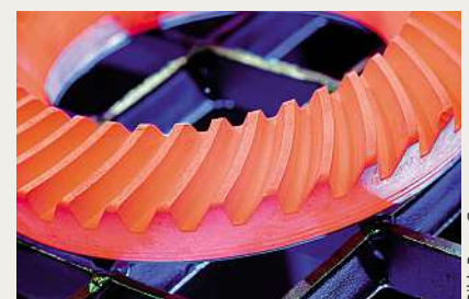
Glühendes Zahnrad während des Härtingsprozesses.
